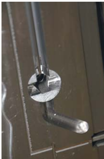
Mit dieser einfachen Weiche können die jeweiligen Kavitäten für den großen und den kleinen Speiß gezielt freigeschaltet oder blockiert werden.
