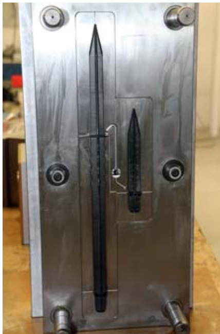
Die Werkzeuge sind jeweils als Einfach-Werkzeug ausgelegt – der lange und der kurze Erdspeiß können in der gleichen Form gefertigt werden.
